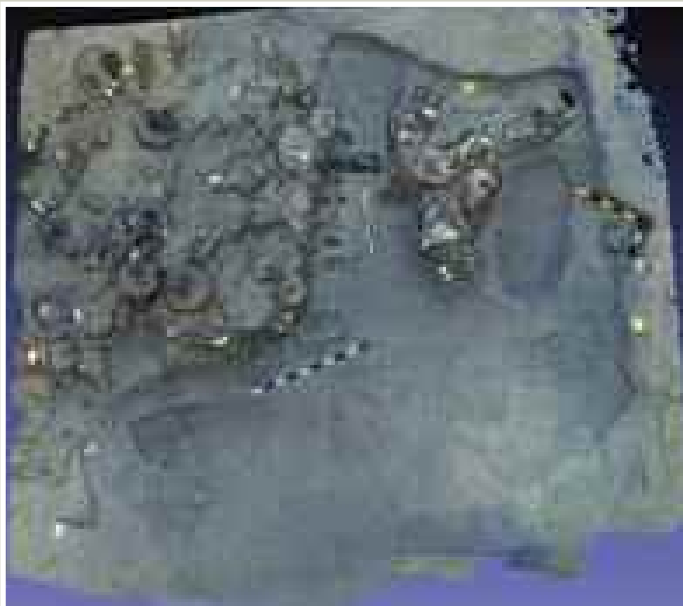
Τρισδιάστατη απεικόνιση του σκάμματος, αποτελούμενη από εκατομμύρια έγχρωμα σημεία (2011, Δ. Σκαρλάτος, © Τεχνολογικό Πανεπιστήμιο Κύπρου).
